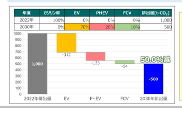
車両入替完了後の車両単位の CO2排出削減量から、2030年の 全体のCO2排出量を示し、裏付 けのある削減目標を設定します。 また、CO2排出削減量目標をレポートとして提供いたします。
