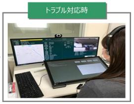
※画面にトラブル車両の位置情報、契約情報、車 内カメラによる車内の様子が表示されています。
